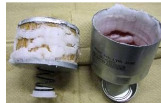
走行不良発生時の燃料フィルタにワックスが詰まっている様子
